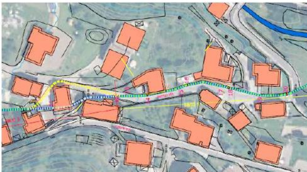
Figura 12. Tratto interessato dai lavori con evidenziato (giallo) il nuovo tracciato per by-passare l'edificio (sedime originario in azzurro) e verde (proseguimento lungo via Cesure)
